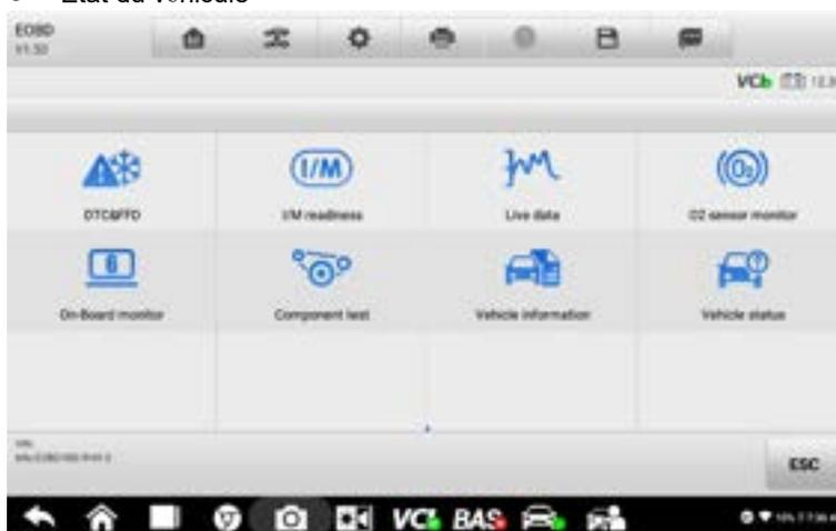
Figure 9-16 Exemple de menu de diagnostic OBDII
