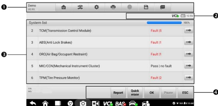
Figure 9-7 Exemple d'écran d'opération de balayage automatique
