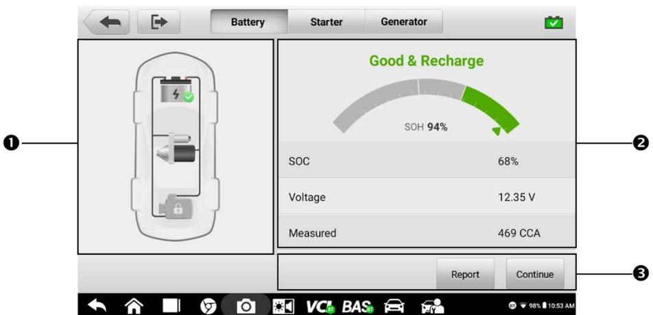
Figure 4-5 -Exemple d' écran de résultat du test de la batterie
